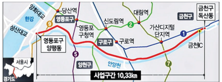
영등포구 양평동 성산대교 남단에서 금천구 독산동 서해안고속도로 금천IC까지 연결하는 서부간선지하도로가 지난 1일 정오에 개통됐다. 서부간선지하도로는 지하 80m 깊이에 직통으로 잇는 10.33km의 왕복 4차로 대심도 지하 터널로 지난 2016년 3월 첫 삽을 뜨지 5년 6개월 만에 완공됐다.
